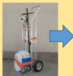
スタンドパイプ式 初期消火器具（可搬式）
